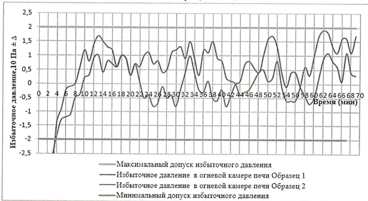
Рисунок 3. График избыточного давления при испытаниях образцов
