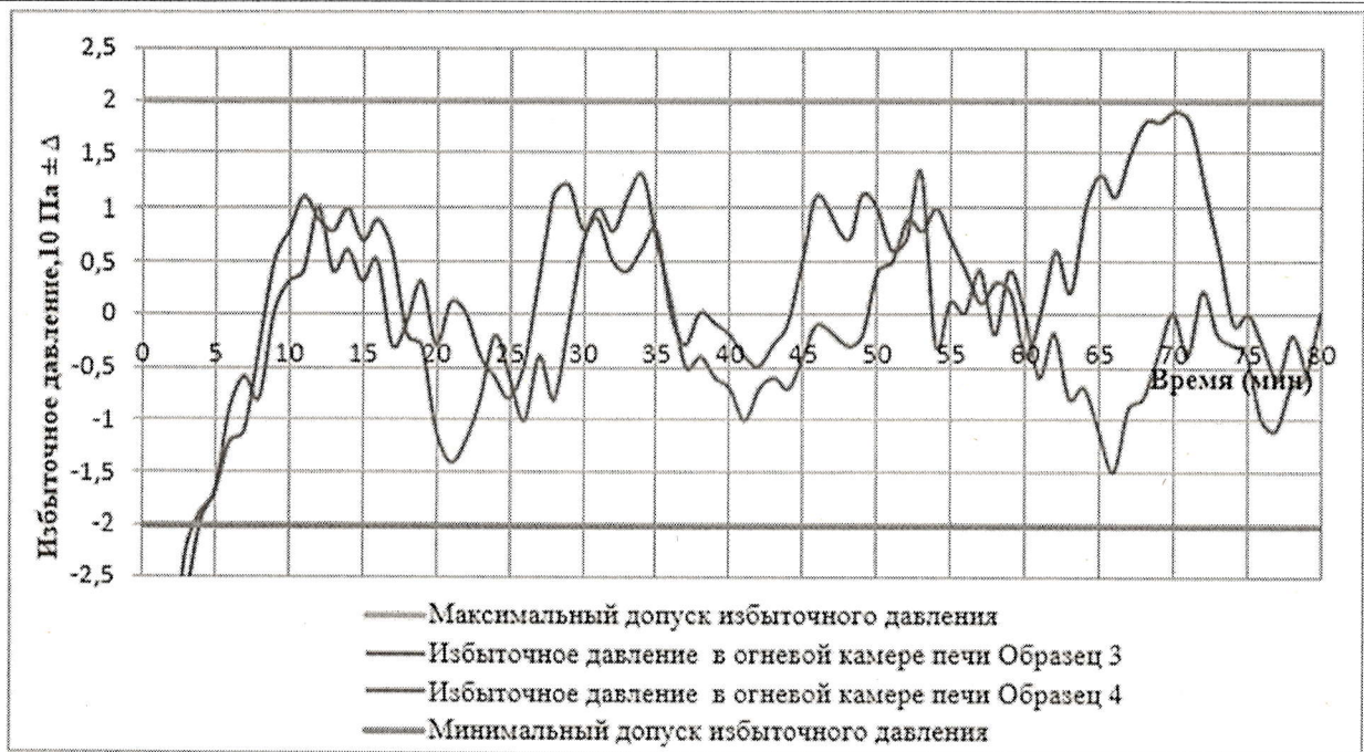
Рисунок 10. График избыточного давления при испытаниях образцов №№ 3, 4
