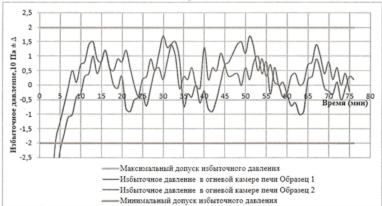
Рисунок 3. График избыточного давления при испытаниях образцов №№ 1, 2
