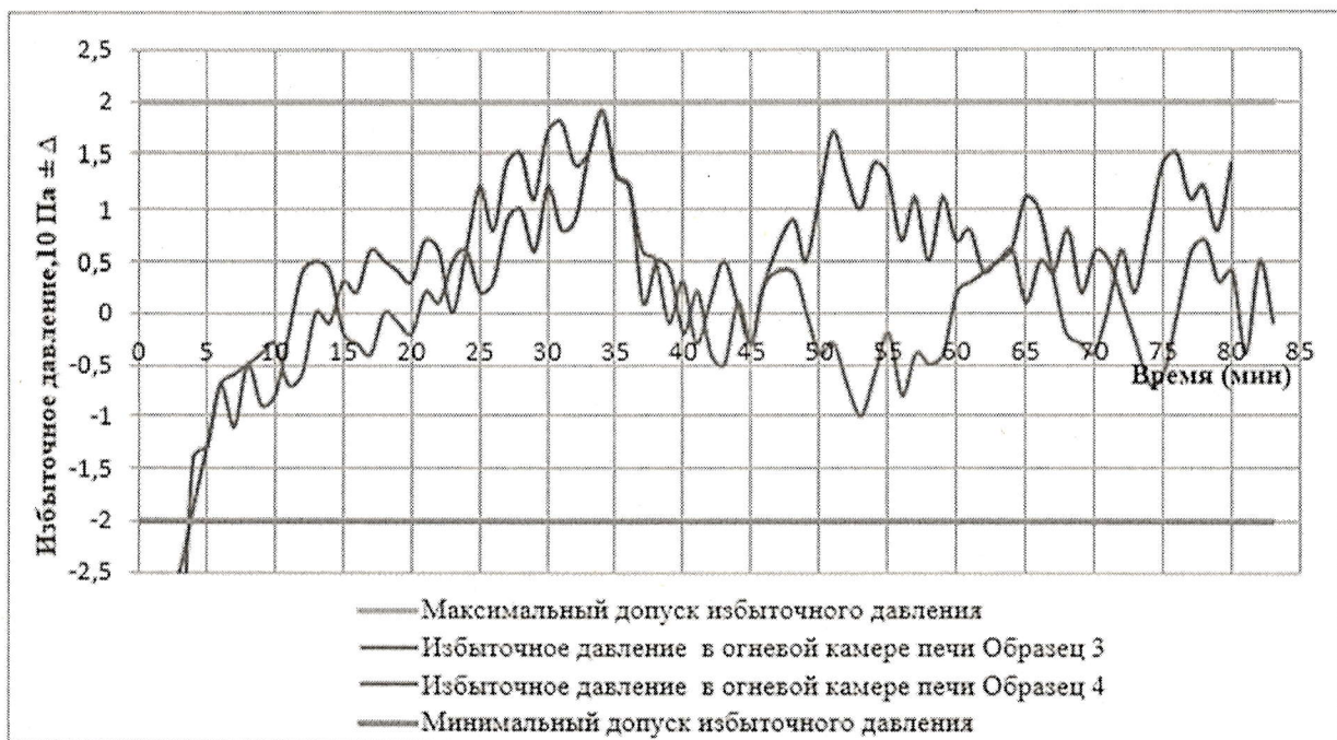
Рисунок 10. График избыточного давления при испытаниях образцов №№ 3, 4
