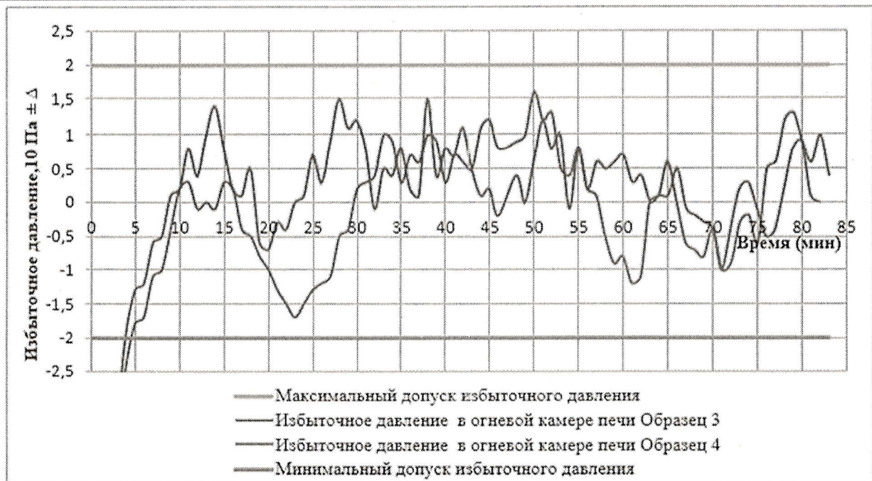
Рисунок 10. График избыточного давления при испытаниях образцов №№ 3, 4
