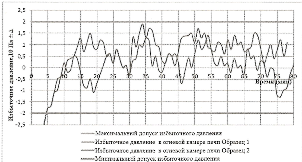
Рисунок 3. График избыточного давления при испытаниях образцов №№ 1, 2
