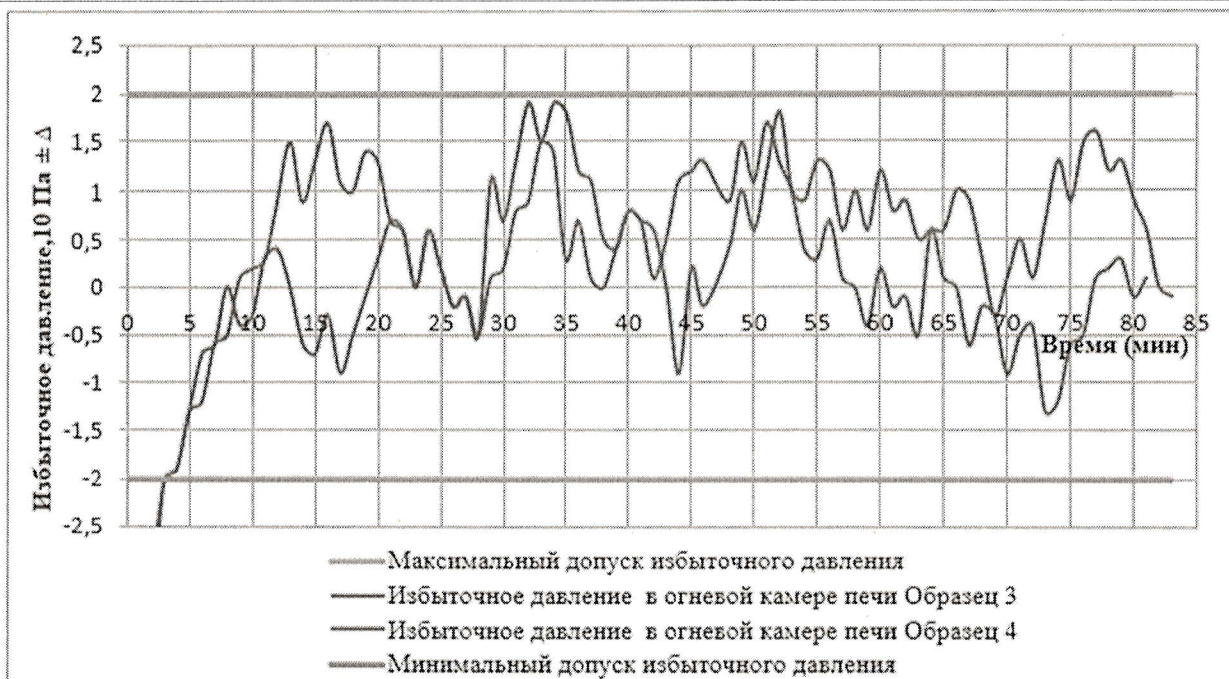
Рисунок 10. График избыточного давления при испытаниях образцов №№ 3, 4
