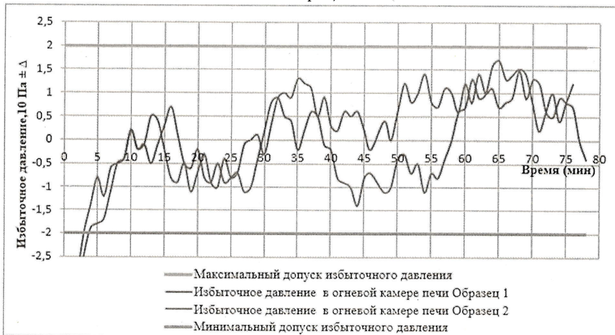
Рисунок 3. График избыточного давления при испытаниях образцов №№ 1, 2
