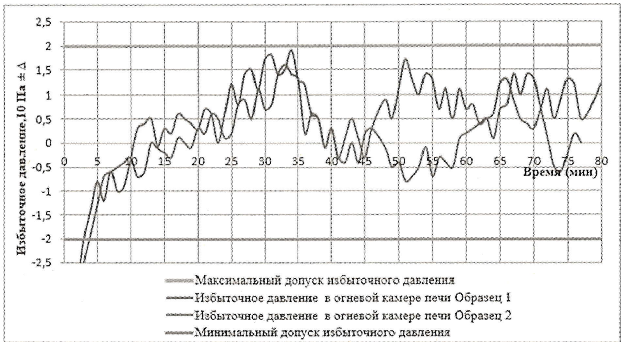
Рисунок 3. График избыточного давления при испытаниях образцов №№ 1, 2
