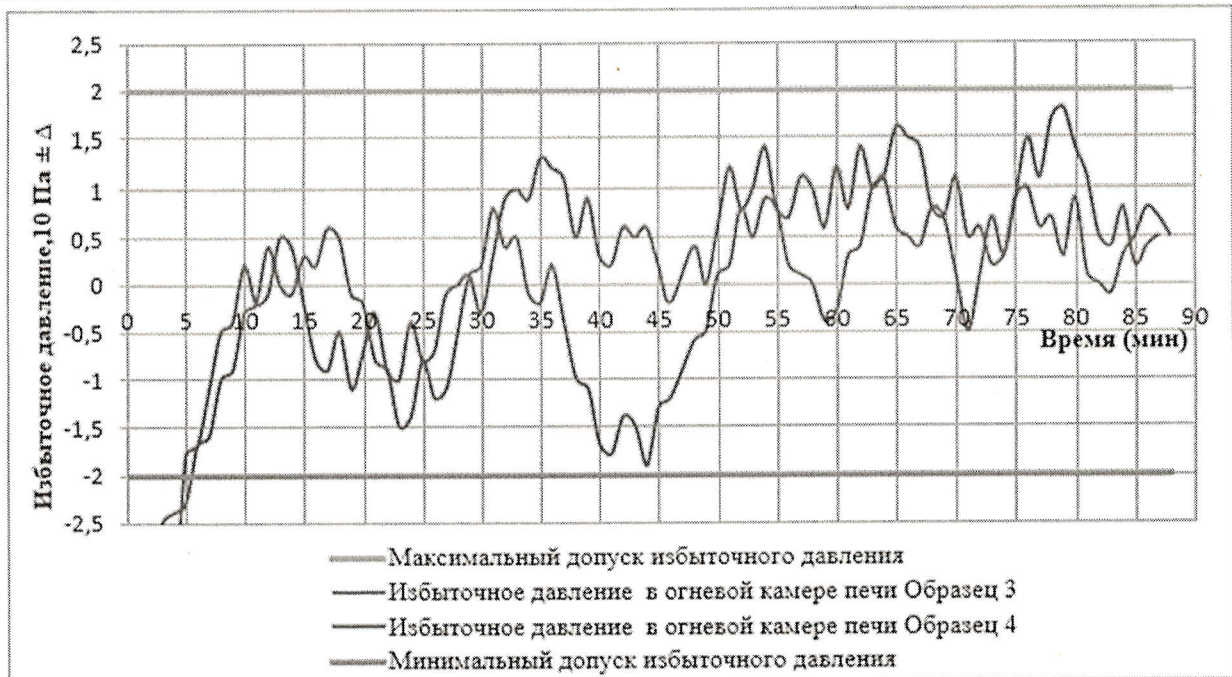
Рисунок 10. График избыточного давления при испытаниях образцов №№ 3, 4
