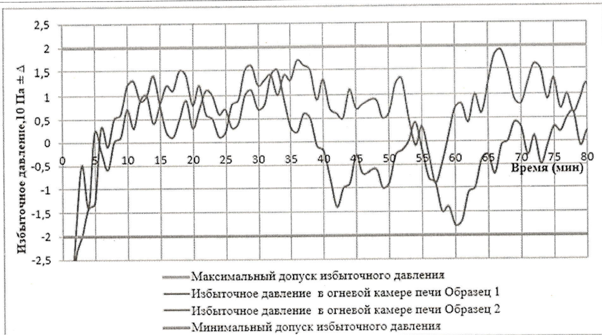
Рисунок 3. График избыточного давления при испытаниях образцов №№ 1, 2
