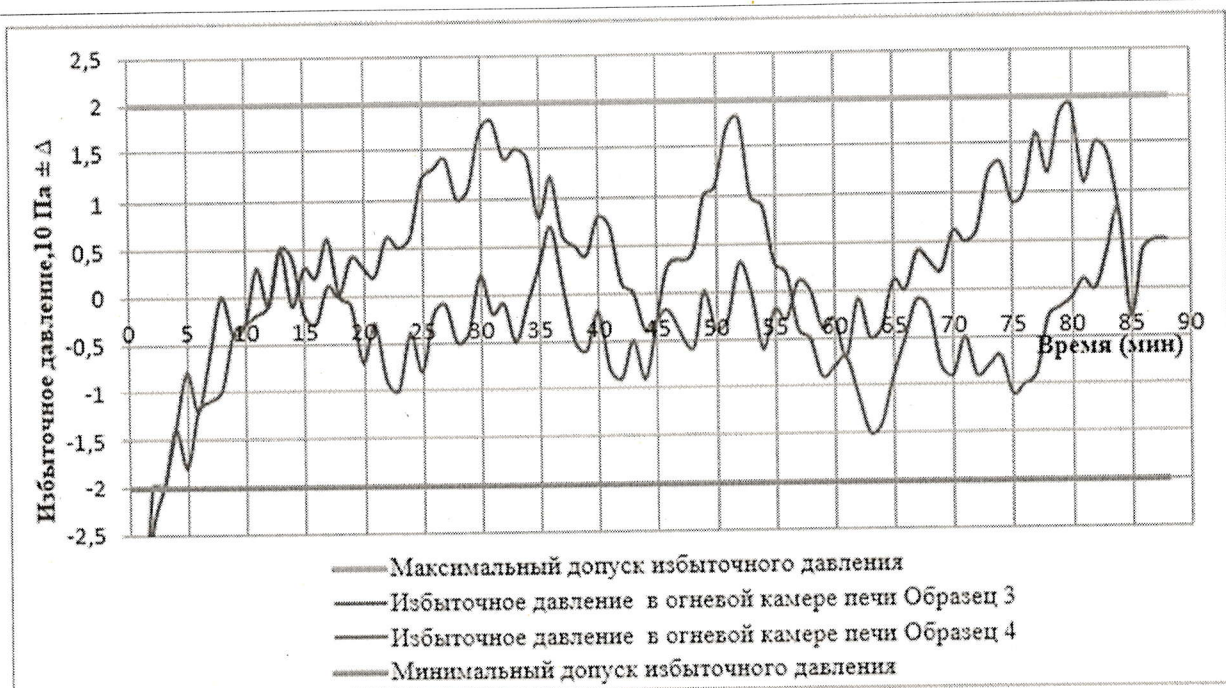
Рисунок 10. График избыточного давления при испытаниях образцов №№ 3, 4
